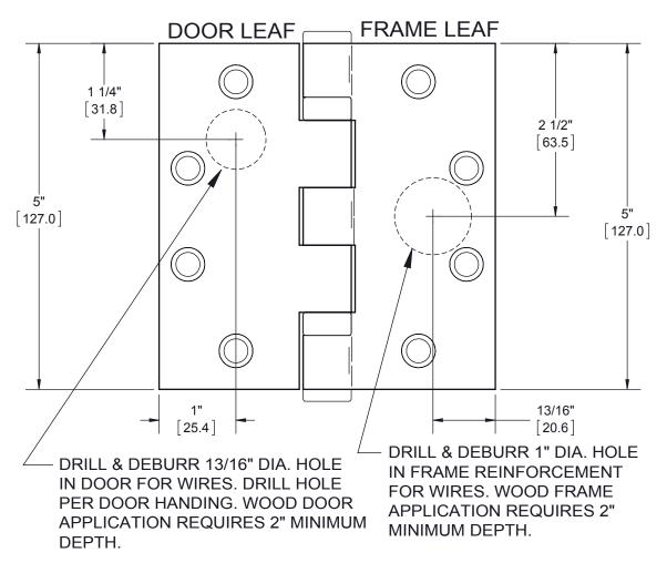
HINGES ARE SHOWN FROM THE FRONT SIDE. HAND HINGE AS SHOWN.
